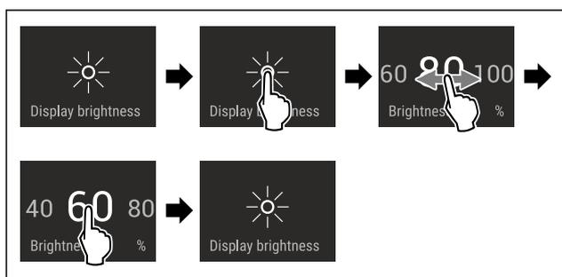
Fig. 60 Représentation à titre d'exemple : Passer de 80 à 60 %.
