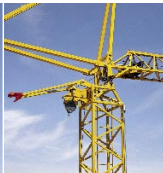
Répartition homogène des efforts sur la mâture grâce à l'articulation du pied de flèche en position médiane.
