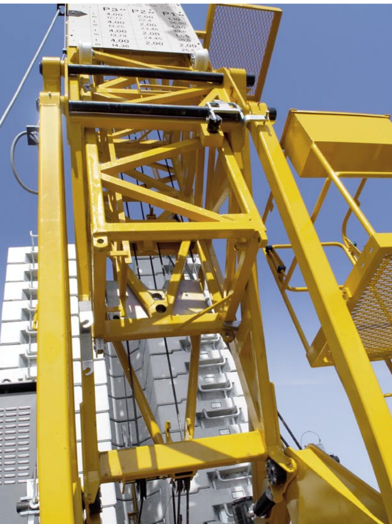
Télescopage d'éléments de mâture supplémentaires pour de plus grandes hauteurs sous crochet.
