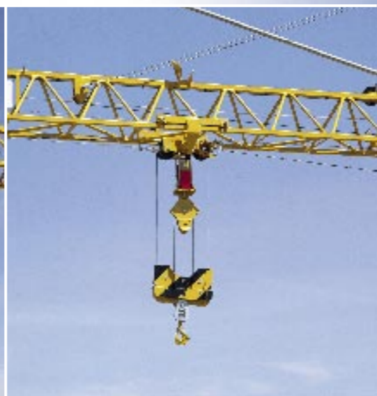
Le changement de mouflage automatique breveté.
