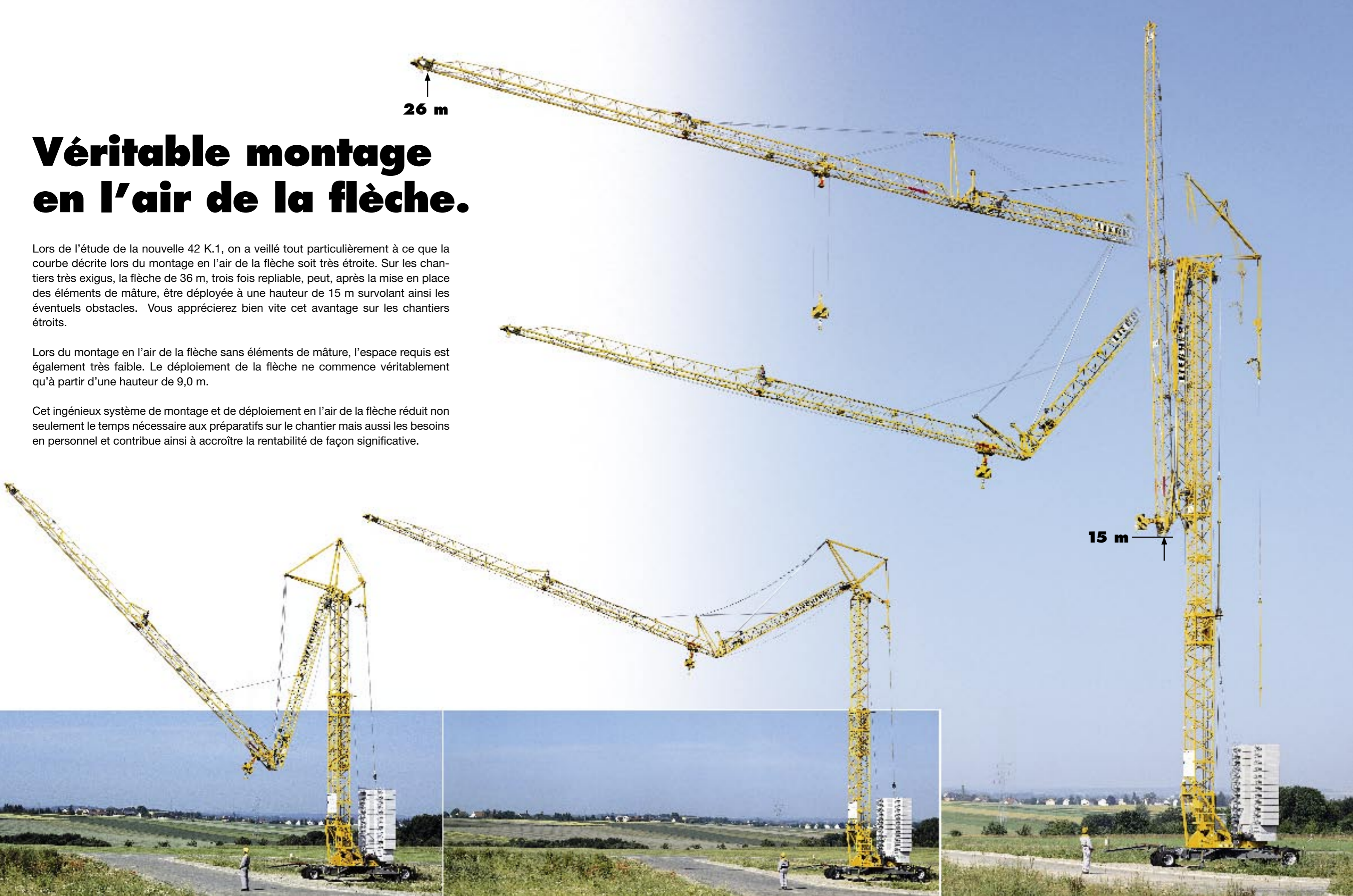
Le montage en l'air de la flèche sans éléments de mâture.
