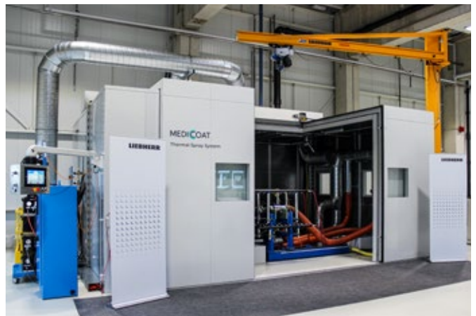
Im neuen Gebäude der Liebherr-Aerospace in Lindenberg für Oberflächenbehandlung kommt die neueste HVOF-Technologie zum Einsatz.
