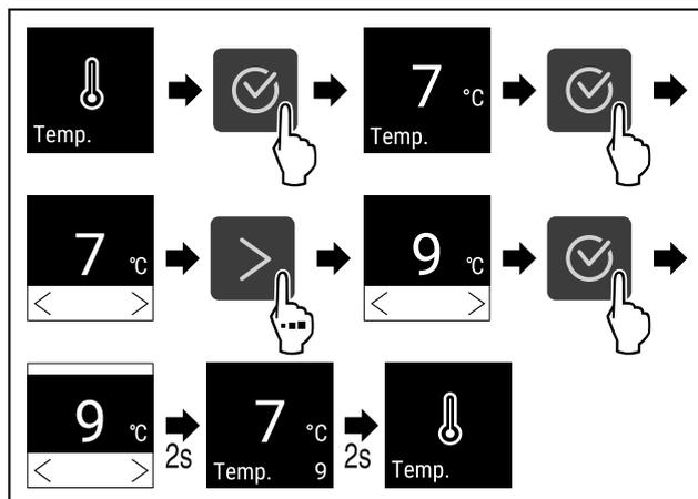
Fig. 59 Variazione di temperatura da 7 °C a 9 °C
