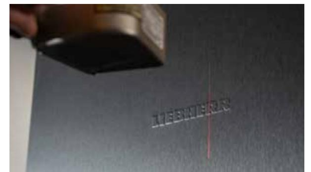
Mit modernster Lasertechnologie wird die gesamte Türoberfläche sowie die Präzision des Liebherr-Schriftzugs kontrolliert – für Qualität bis ins kleinste Detail.
