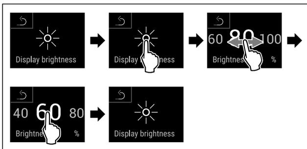
Fig. 105 Beispielhafte Darstellung: Von 80 % zu 60 % wechseln.
