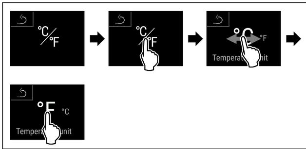
Fig. 103 Beispielhafte Darstellung: Von Grad Celsius zu Grad Fahrenheit wechseln.
