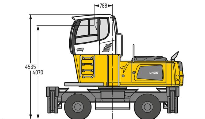
En una elevación de cabina rígida, la cabina se monta de forma fija en una posición elevada. Si es necesaria una altura de transporte menor, la elevación de la cabina de conducción debe desmontarse y sustituirse por un dispositivo de transporte. En esta versión de la máquina, la cota 4.535 mm es de 3.639 mm para todas las elevaciones rígidas de la cabina.
