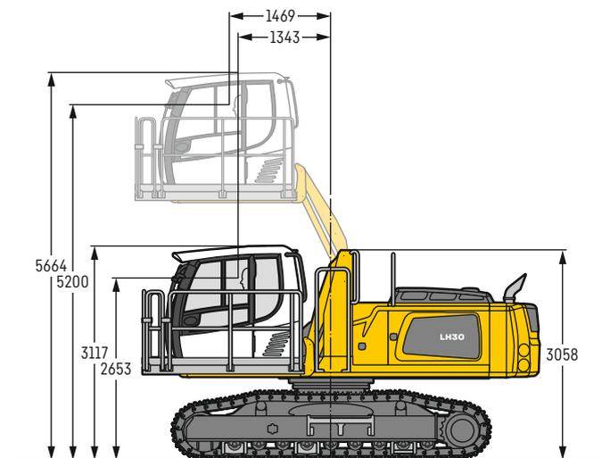
Con la cabina ajustable hidráulicamente en altura, el operador podrá seleccionar y ajustar libremente en todo momento su campo visual dentro de la elevación de cabina.
