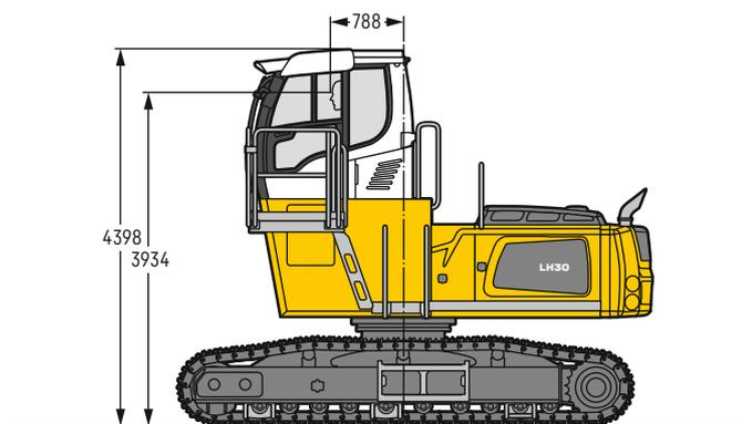
En una elevación de cabina rígida, la cabina se monta de forma fija en una posición elevada. Si es necesaria una altura de transporte menor, la elevación de la cabina de conducción debe desmontarse y sustituirse por un dispositivo de transporte. En esta versión de la máquina, la cota 4.398 mm es de 3.502 mm para todas las elevaciones rígidas de la cabina.
