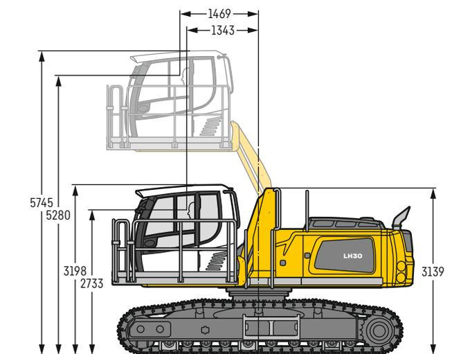
Con la cabina ajustable hidráulicamente en altura, el operador podrá seleccionar y ajustar libremente en todo momento su campo visual dentro de la elevación de cabina.
