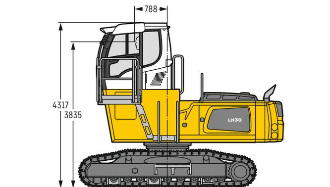
En una elevación de cabina rígida, la cabina se monta de forma fija en una posición elevada. Si es necesaria una altura de transporte menor, la elevación de la cabina de conducción debe desmontarse y sustituirse por un dispositivo de transporte. En esta versión de la máquina, la cota 4.317 mm es de 3.421 mm para todas las elevaciones rígidas de la cabina.
