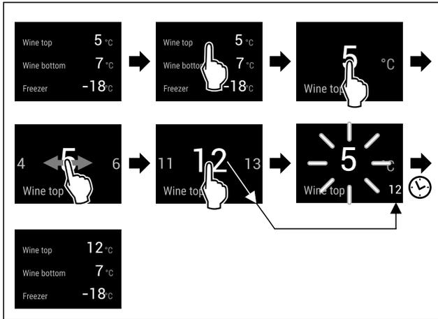
Fig. 21 Beispielhafte Darstellung: Temperatur im oberen Weinteil einstellen.
