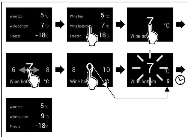
Fig. 22 Beispielhafte Darstellung: Temperatur im unteren Weinteil einstellen.
