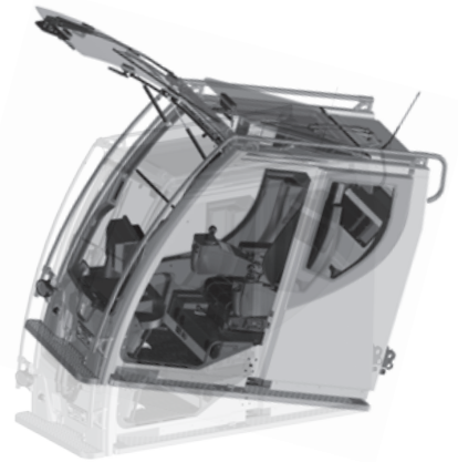
Kippbare Kabine: um 20° nach hinten neigbar
