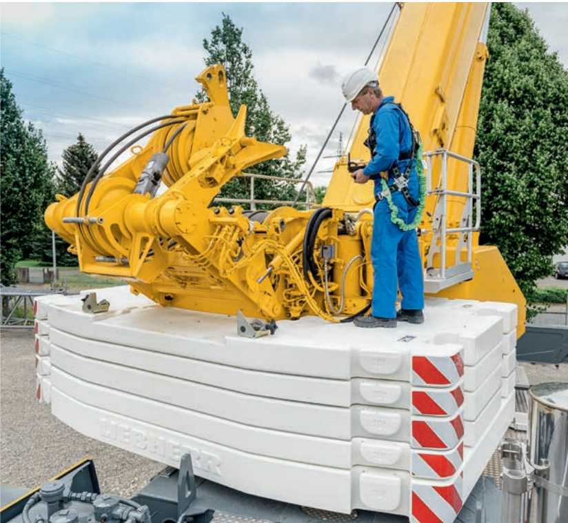
Selbstmontage der Winde 2 beim LTM 1300-6.2
