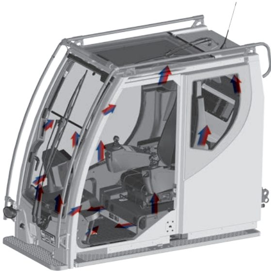
Intelligentes Heiz- und Belüftungssystem, Klimaanlage serienmäßig
