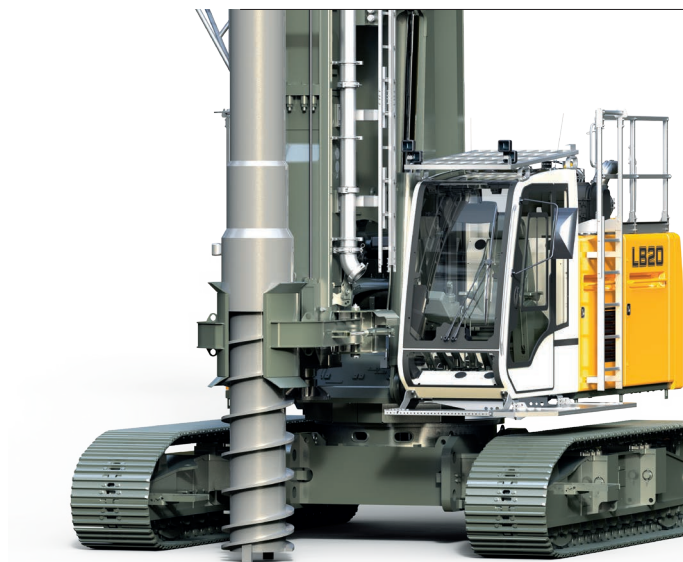
Шнек и направляющая для грунтовытесняющих свай
