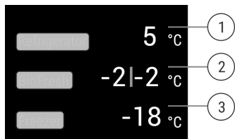
Fig. 8 Status display shows the actual temperature.*
