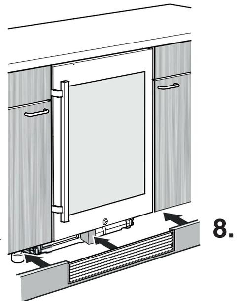
8. Sockelblende aufsetzen. Das Schaumformteil wird dabei nach hinten in seine endgültige Position verschoben.
