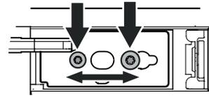
24. Schrauben lösen und Scharnierwinkel nach rechts oder links verschieben.
