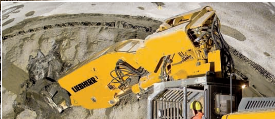
Schutz von Ausleger und Hydraulikzylindern
