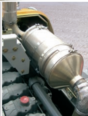
Dieselpartikelfilter unter Verkleidung
