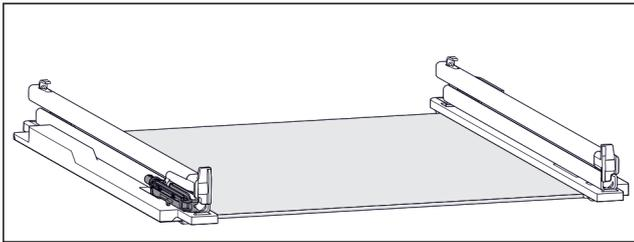
Fig. 124 Dämpfungseinheit
