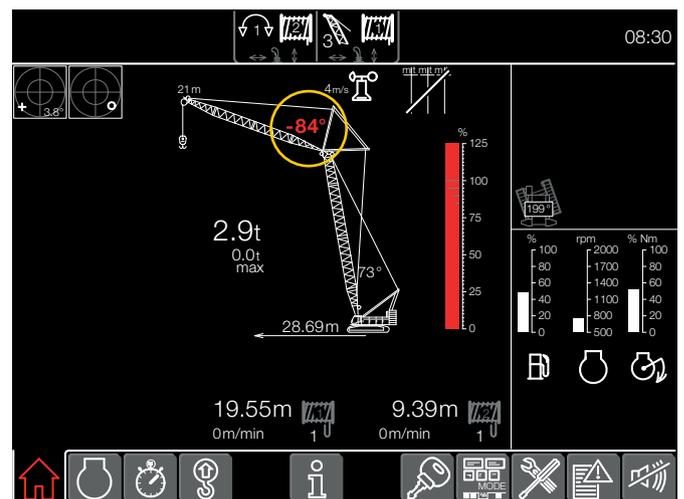
Der Kranfahrer erhält eine optische Warnung, bevor der Kippwinkel der Nadelausleger-Rückfallstützen erreicht wird.
