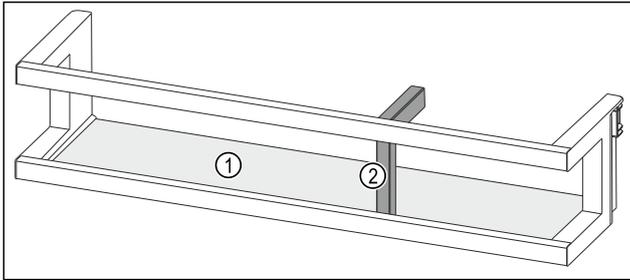
Fig. 50 Representación a modo de ejemplo del estante en la contrapuerta con soporte para botellas
