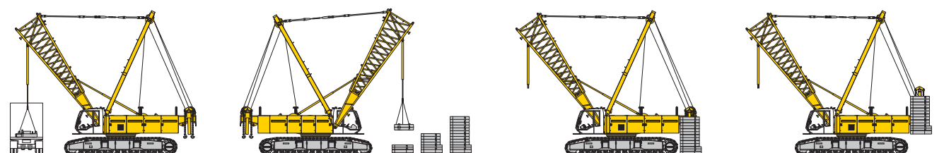
Entladung, Zusammen- und Anbau des Gegengewichtes
