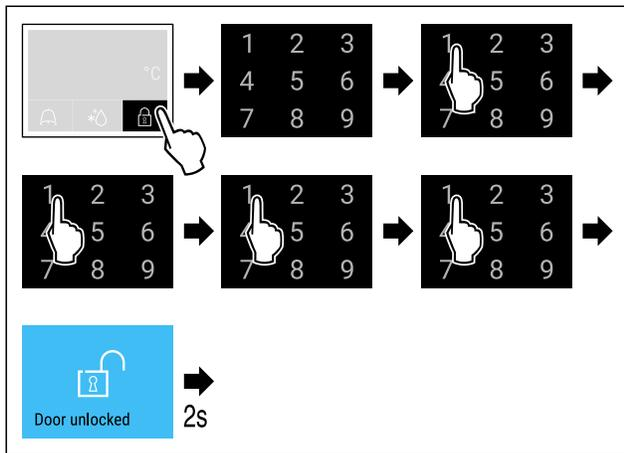
Fig. 77 Unlock door with door code 1 1 1 1.
