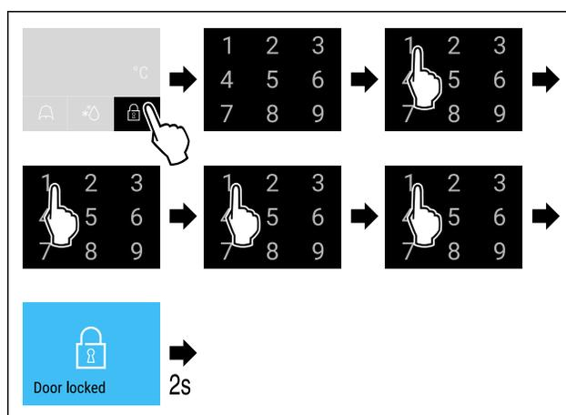
Fig. 74 Locking door using door code 1 1 1 1.
