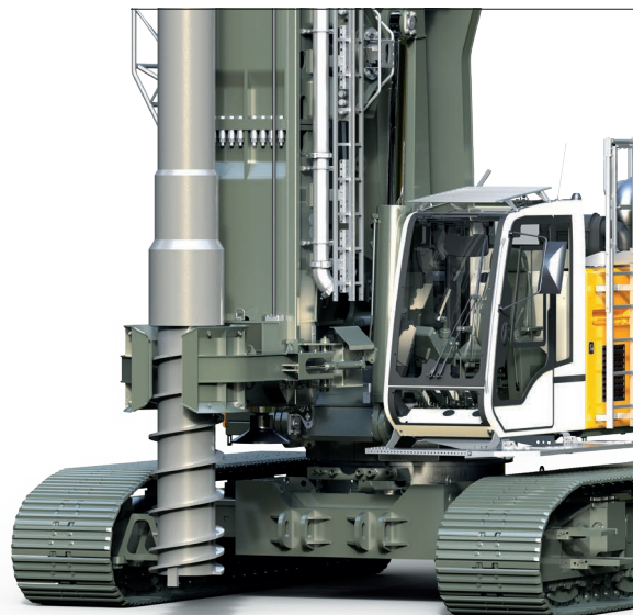
Шнек и направляющая для грунтовытесняющих свай
