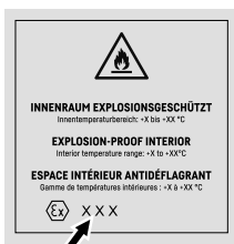
Fig. 3 Clase de protección: II 3/-G Ex ec IIC T6 Gc/-
