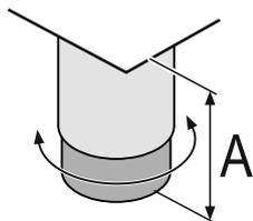
Fig. 12 Le pied de réglage est réglable de  $A = 150 \text{ mm}$  ( $6 \frac{5}{16} \text{ in}$ ) à  $180 \text{ mm}$  ( $7 \frac{1}{16} \text{ in}$ ).\*
