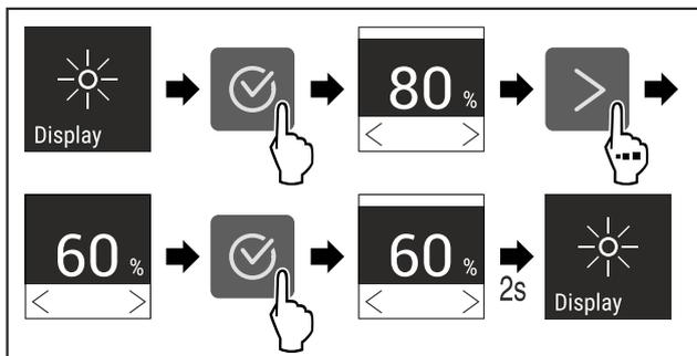
Fig. 85 Représentation à titre d'exemple : Passer de 80 à 60 %.
