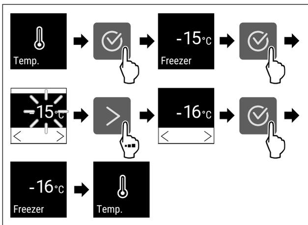
Fig. 66 Changement de température de -15 °C à -16 °C
