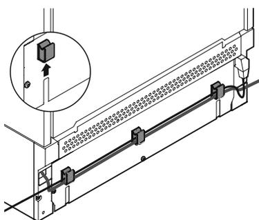
Montare i portacavi sul retro dell'apparecchio. Inserire il cavo di rete/tubo dell'acqua nei portacavi.
