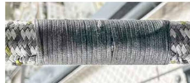
Die Reparatur mittels Fibre-Reparaturkit stellt einen signifikanten Vorteil gegenüber Stahlseilen dar, bei denen es eine solche Option nicht gibt. Ist der Schaden des Seils irreparabel mit dem Fibre-Reparaturkit, schafft die Möglichkeit zur Seilkürzung Abhilfe, ähnlich wie sie beim Stahlseil bereits Standard ist. Aufgrund des höheren Werts des Faserseils ist die Seilkürzung bei der Fibre-Technologie wirtschaftlich attraktiver. *Erfahren Sie mehr auf den Seiten 9 und 23.*
