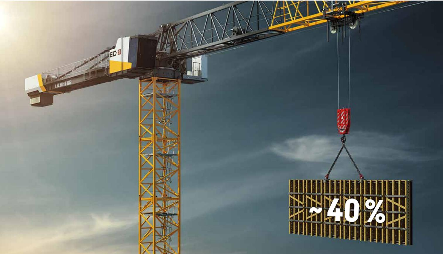
Fibre-Krane punkten besonders mit ihrer starken Leistungsfähigkeit, sodass die Tragfähigkeiten der bestehenden Systeme v.a. Türme und Unterbauten deutlich verbessert werden. Zusätzlich zum 80 % geringeren Seilgewicht werden auch Bauteile wie die Hakenflasche leichter ausgeführt.
