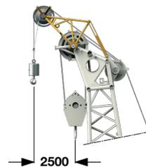
Этот вспомогательный оголовок может использоваться для грузов до 50 т. Соответствующая таблица грузоподъёмности запрограммирована в системе LMI.
