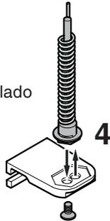
5. Cambiar los elementos de la bisagra superior al lado opuesto.
