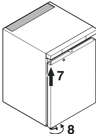
8. Introducir el soporte de bisagra en la bisagra inferior de la puerta. Girar 90° el soporte de bisagra - el resorte se tensa. Atornillar el soporte de bisagra.
