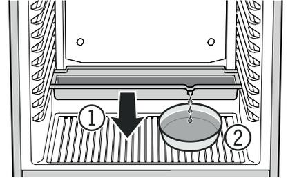
**El recipiente para el agua de descongelación solo se puede insertar en la nervadura de apoyo más baja.**
