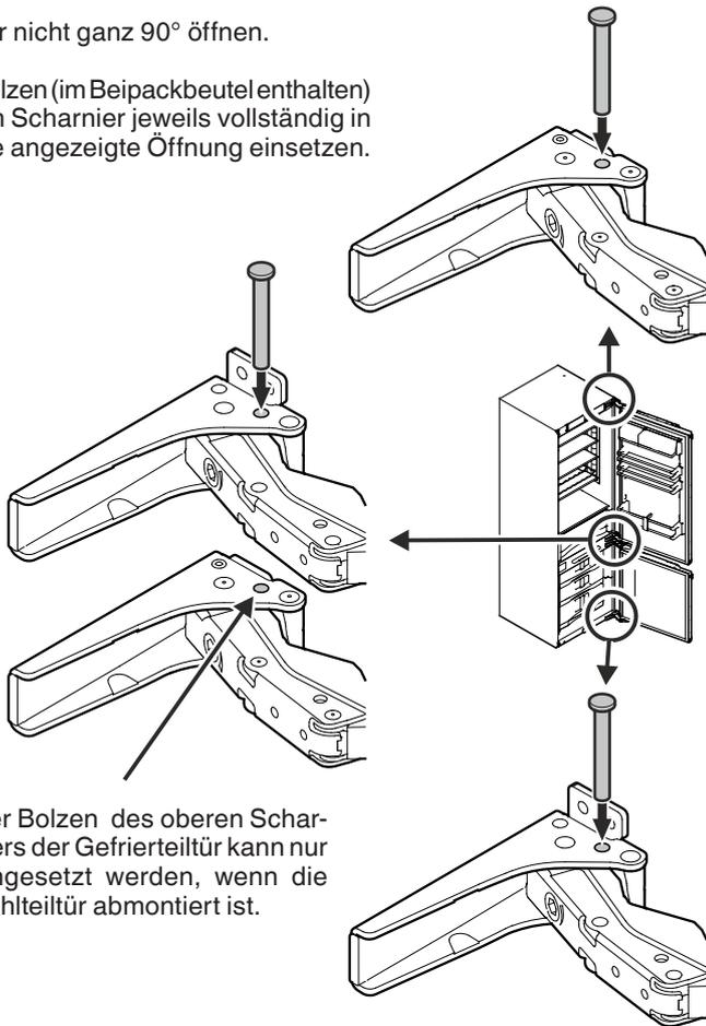
Der Bolzen des oberen Scharniers der Gefrierteiltür kann nur eingesetzt werden, wenn die Kühlteiltür abmontiert ist.
