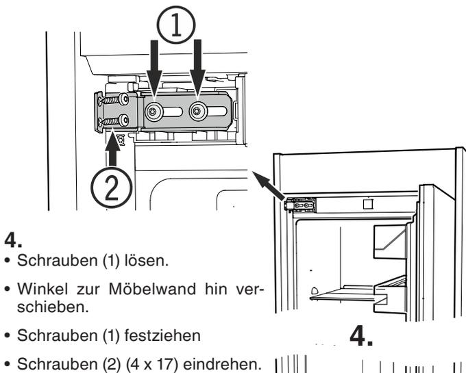
**Einbauvariante mit außenliegendem Türpaneel**
