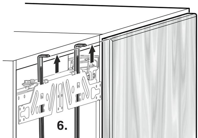
**Einbauvariante mit innenliegendem Türpaneel**
