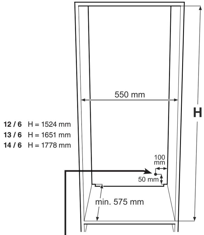
In diesem Bereich kommt die Netzzuleitung aus der Rückseite des Gerätes.
