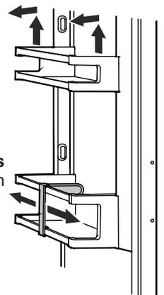
Durch Verschieben des **Flaschenhalters** können Sie Flaschen gegen Umkippen beim Türöffnen und -schließen sichern.
