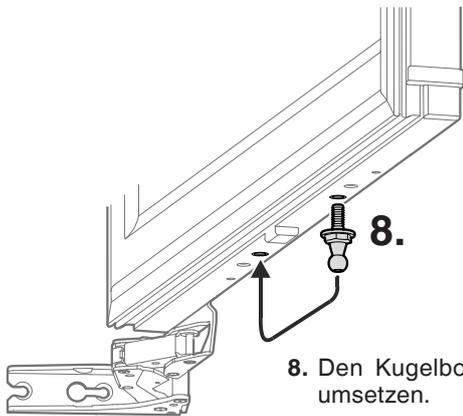
8. Den Kugelbolzen der Kühlteiltür umsetzen.
