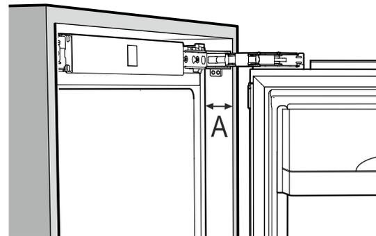
Einbauvariante mit außenliegendem Türpaneel
