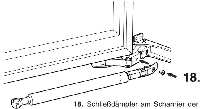
18. Schließdämpfer am Scharnier der Gefrierteiltür anschrauben.
