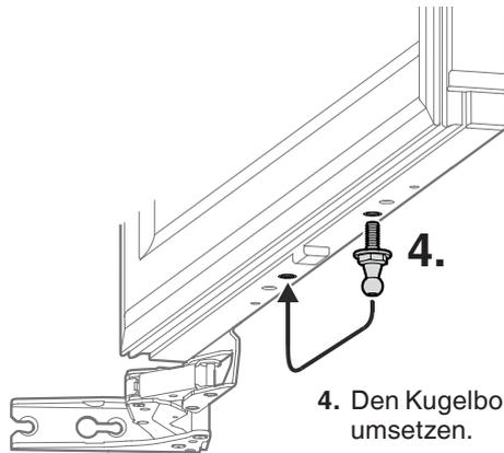
4. Den Kugelbolzen der Gefrierteiltür umsetzen.
