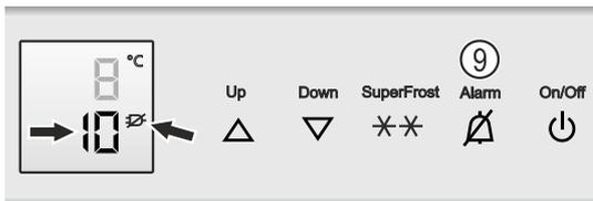
**Alarm**-Taste (9) drücken um die Anzeige zu löschen.
