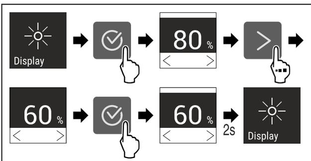
Fig. 96 Représentation à titre d'exemple : Passer de 80 à 60 %.
