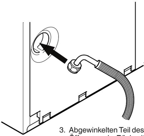
3. Abgewinkelten Teil des Schlauches durch die Öffnung an der Rückseite des Gerätes stecken.
