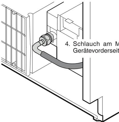
4. Schlauch am Magnetventil an der Gerätevorderseite anschließen.
