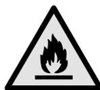
**WARNUNG:** Brandgefahr / brennbare Materialien. Das Symbol befindet sich am Verdichter und kennzeichnet die Gefahr vor feuergefährlichen Stoffen. Den Aufkleber nicht entfernen.
