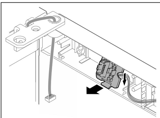
Fig. 22 插头架的安装位置可以转动180°。
