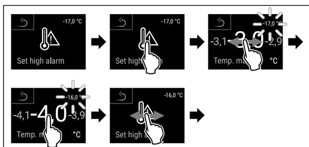
Fig. 186 设置温度上限的示例，基于 -20 °C 的已设置的冰箱温度。
