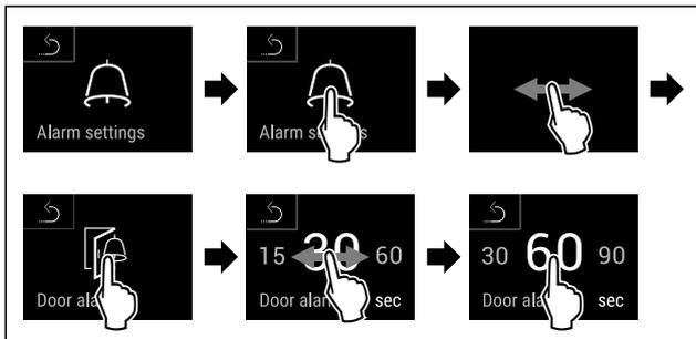
Fig. 199 例图：将门开警报从 30 秒钟切换到 60 秒钟。
