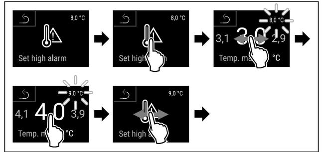
Fig. 179 设置温度上限的示例，基于 5 °C 的已设置的冰箱温度。
