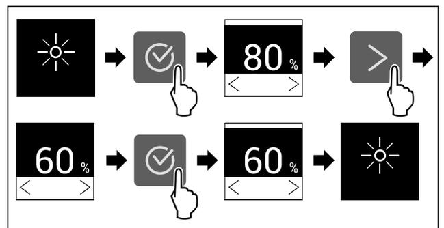
Fig. 71 Beispielhafte Darstellung: Von 80 % zu 60 % wechseln.
