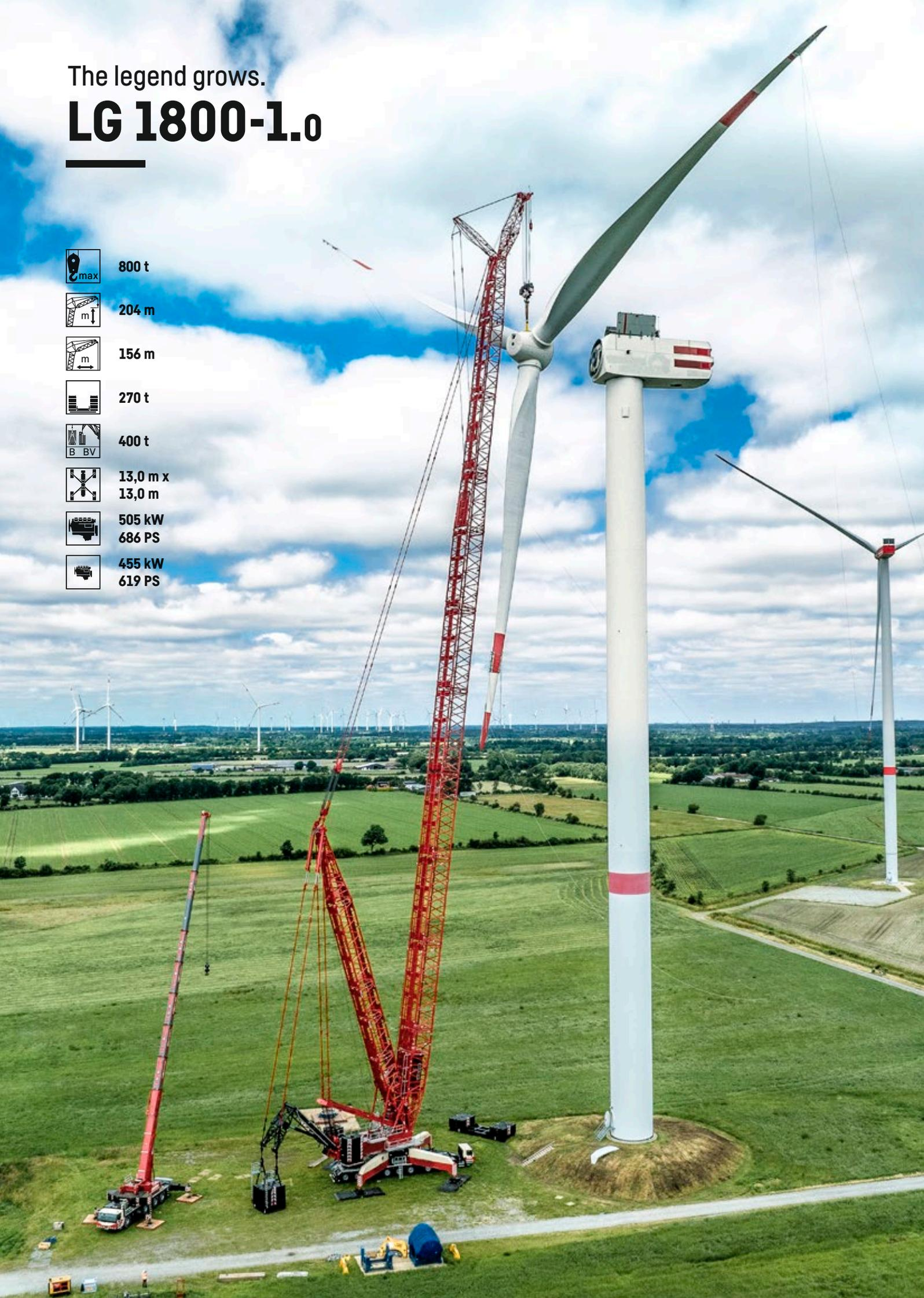
O LG 1800-1.0 combina a mobilidade de um guindaste todo terreno com as altas capacidades de carga de um guindaste com lança treliçada. O LG 1800-1.0 também possui tecnologia de última geração em guindastes, como o V-Frame®, o VarioTray®, a transmissão ZF TraXon Torque com ECOdrive e tabelas de carga para velocidades de vento específicas. Além disso: o equipamento do LR 1800-1.0 também pode ser aproveitado para o LG 1800-1.0.
