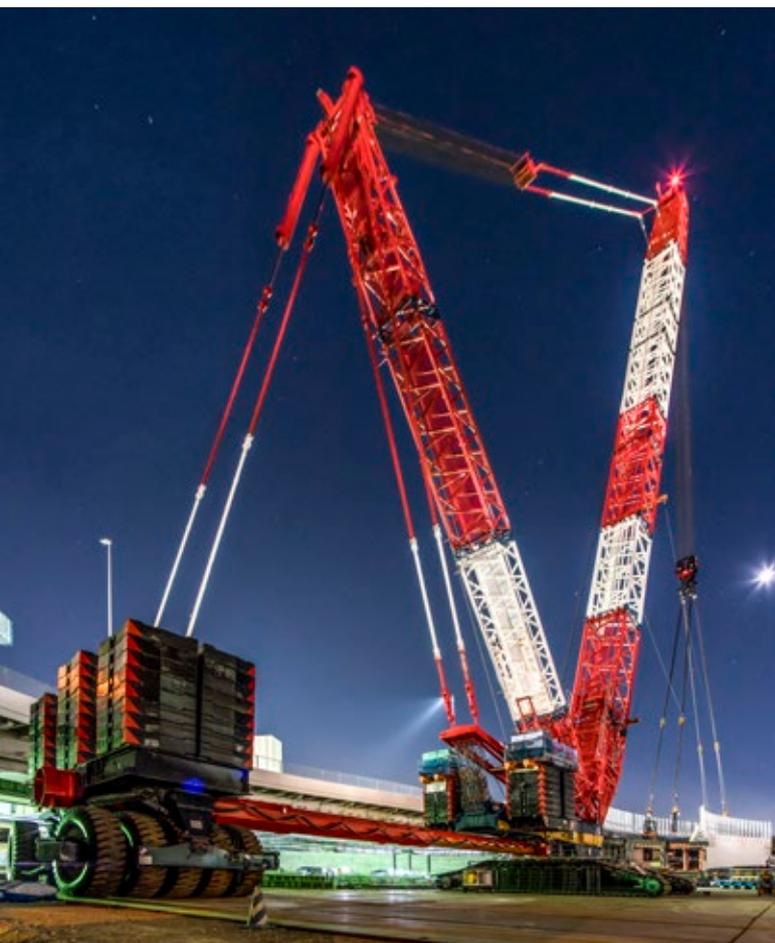
Com o uso do carro do contrapeso, o guindaste sobre esteiras pode circular pelo canteiro de obras enquanto a carga está suspensa no gancho, sem a necessidade de trocar todo o sistema de lastro.
