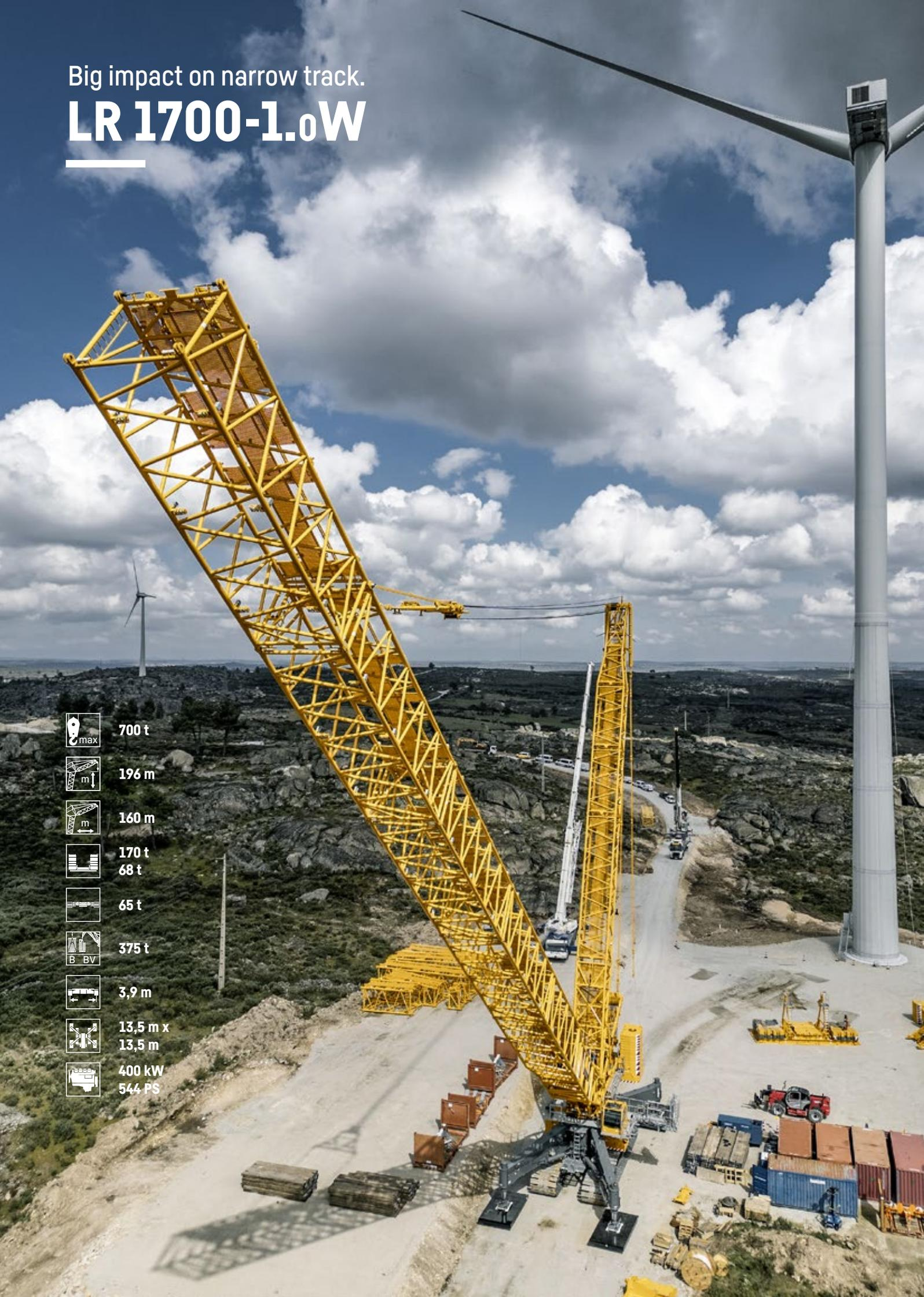
**Área de apoio estreita com altas capacidades de carga:** o LR 1700-1.0W dispõe das melhores condições para a montagem eficiente de turbinas eólicas modernas nos parques eólicos. O guindaste sobre esteiras com chassi estreito está equipado com a mais moderna tecnologia de guindastes sobre esteiras, como um mecanismo de translação para serviços pesados, o guia de contrapeso V-Frame® e o sistema de contrapeso divisível VarioTray®.
