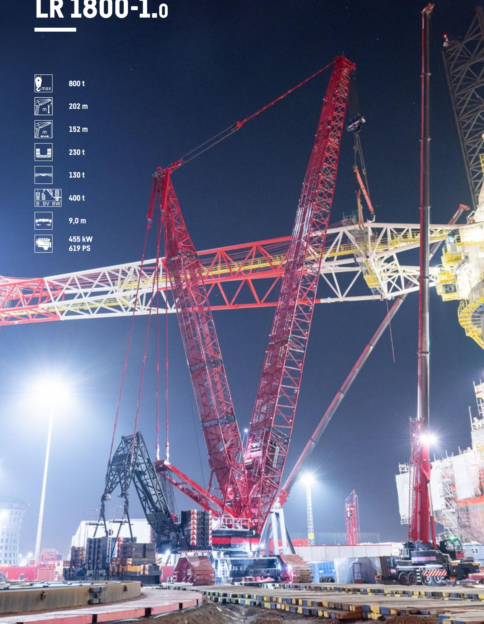
**Excelentes capacidades de carga – e otimizadas para transporte econômico em todo o mundo. O LR 1800-1.0 foi projetado como um guindaste industrial particularmente poderoso para uso com lança basculante e sistema de ancoragem de contrapeso para plantas industriais, construção de usinas de energia ou para o setor petroquímico. Mas este guindaste também oferece muitas vantagens para a montagem de turbinas eólicas ou operações de serviços de parques eólicos.**
