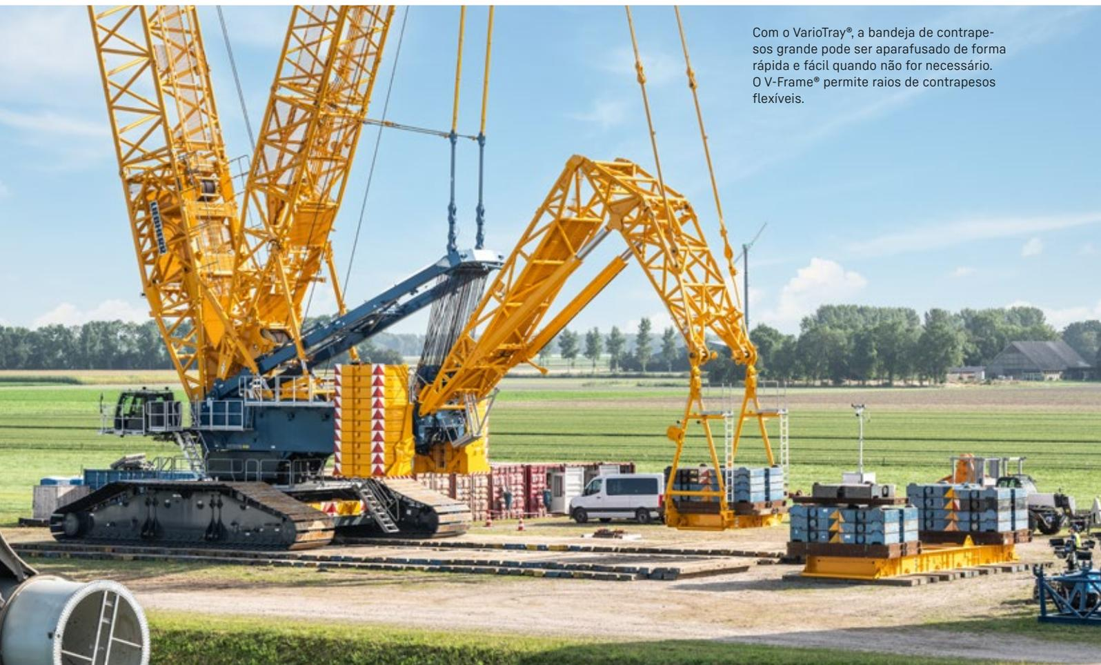
Com o VarioTray®, a bandeja de contrapesos grande pode ser aparafusada de forma rápida e fácil quando não for necessário. O V-Frame® permite raios de contrapesos flexíveis.
