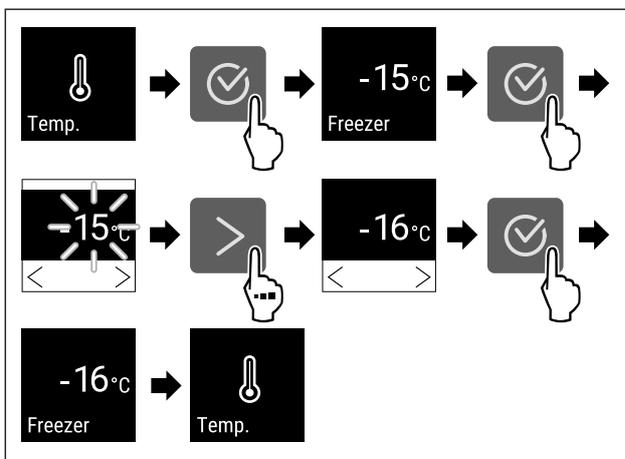
Fig. 66 Variazione di temperatura da -15 °C a -16 °C
