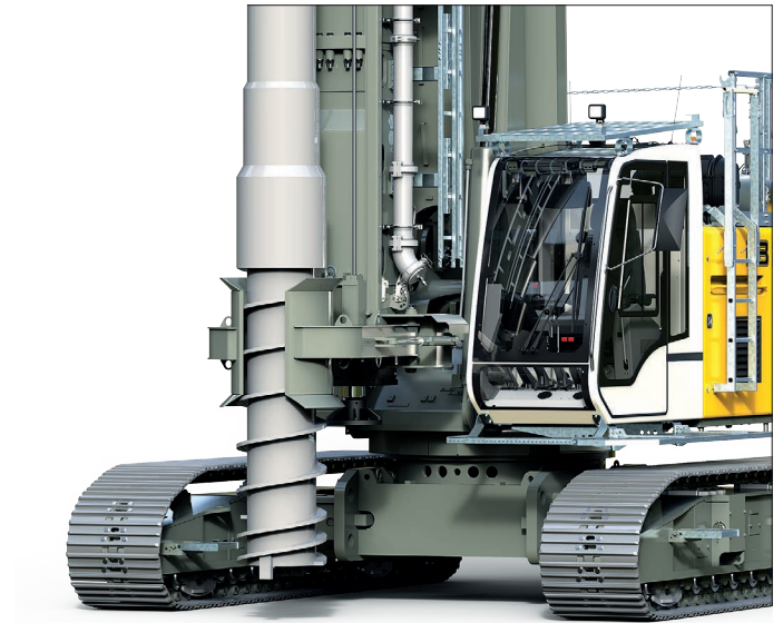
Vollverdränger mit Anbohrführung
