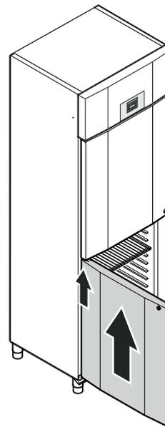
21. Scharnierwinkel mit aufgesetzten Lagerteilen in das untere Türlager einsetzen.
