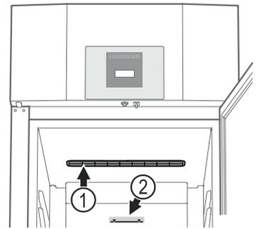
(1) Die Lüftungsschlitze des Umluftgebläses im Innenraum dürfen nicht abgedeckt werden!
