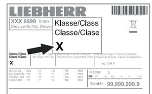
Die Klimaklasse ist auf dem Typenschild aufgedruckt.
