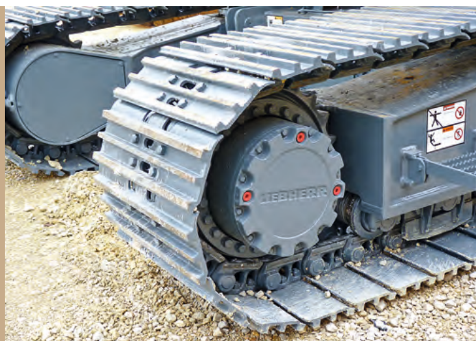
3-Steg-Bodenplatten, Breite 700 mm • triple grouser track pads, Width 700 mm Tuiles à 3 nervures, Largeur 700 mm • 3-file piastre cingoli, Larghezza 700 mm Tejas de 3 perfiles, Anchura 700 mm • 3-рёберные траки, Ширина 700 мм
