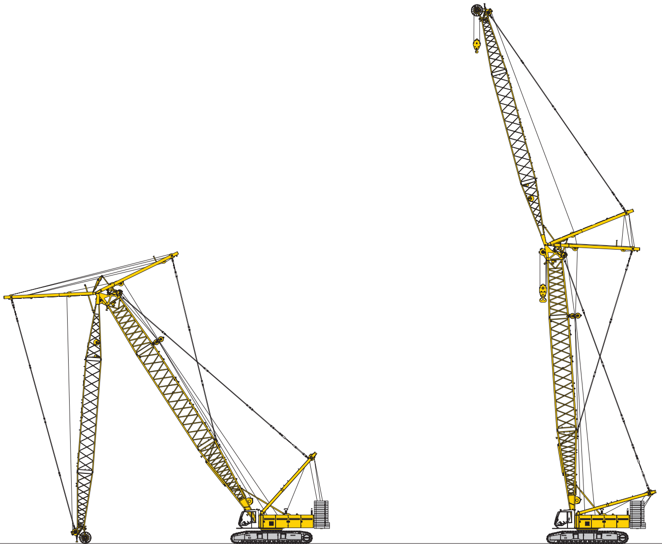
Elevación de la pluma principal y del plumín abatible
