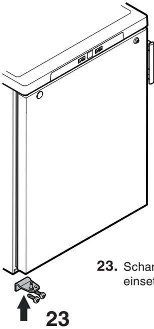
23. Scharnierwinkel in unteres Türlager einsetzen und anschrauben.
