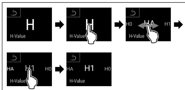
Fig. 77 Beispielhafte Darstellung: Von HA zu H1 wechseln.
