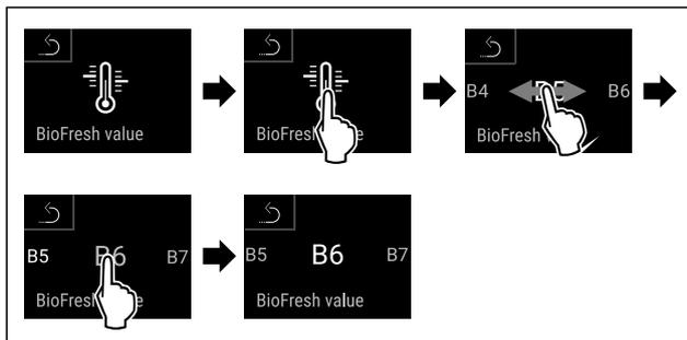
Fig. 25 Beispielhafte Darstellung: Von B5 zu B6 wechseln.
