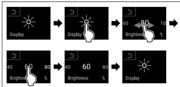
Fig. 75 Beispielhafte Darstellung: Von 80 % zu 60 % wechseln.
