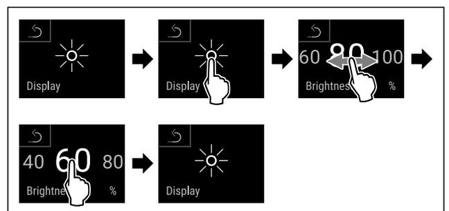
Fig. 49 Beispielhafte Darstellung: Von 80 % zu 60 % wechseln.
