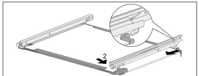
Fig. 92 Placa de vidrio con guías
