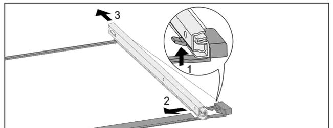
Fig. 91 Placa de vidrio con guías
