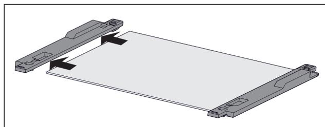
Fig. 97 Placa de vidrio con piezas de sujeción
