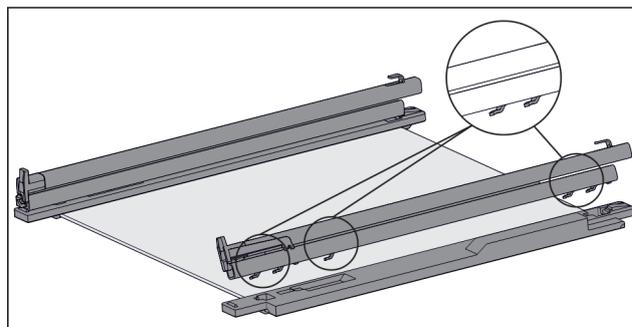
Fig. 96 Placa de vidrio con guías y piezas de sujeción
