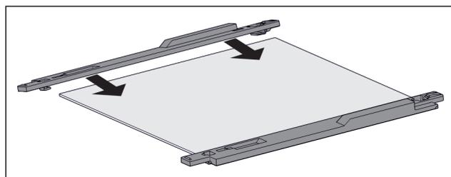
Fig. 98 Placa de vidrio con piezas de sujeción
