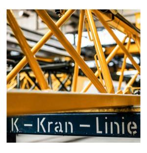
Eine einfache Regel ist: Je länger ein Produkt nutzbar ist, umso wirtschaftlicher ist es. Daher geht Liebherr bei der Langlebigkeit keine Kompromisse ein. Neben hochwertigen Grundmaterialien findet auch die Bearbeitung unter höchsten Standards statt. Daher sind alle freiliegenden Bauteile in Kranen der K-Baureihe dichtverschweißt. So ist kein Eindringen von Wasser und dadurch bedingte Korrosion möglich. Unsere Krane sind für eine hohe Lebensdauer und Einsatzzeit bekannt.
