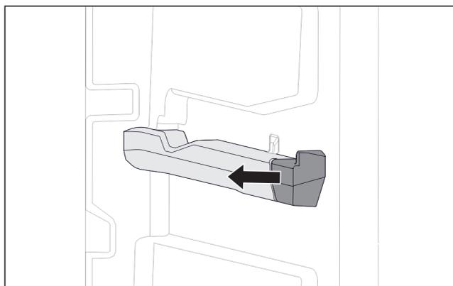
Fig. 119 Elemento inseribile sulla nervatura destra del contenitore
