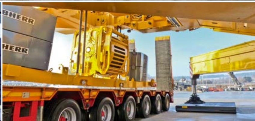
Automontage mécanisme de levage 2
