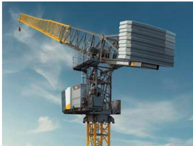
Die leistungsfähigen Hubwerke, bekannt aus der EC-B Baureihe, setzen auf Liebherr-eigene Antriebe.
