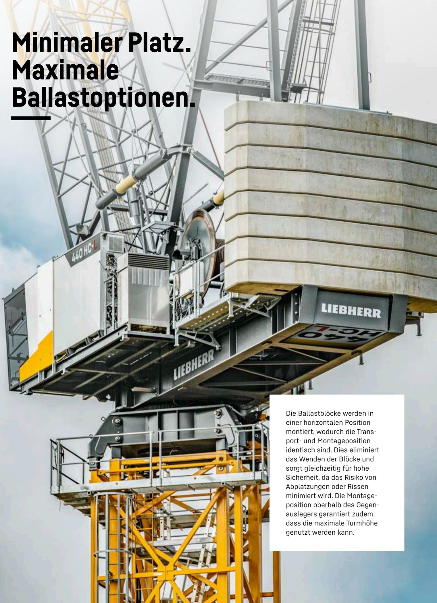
Die Ballastblöcke werden in einer horizontalen Position montiert, wodurch die Transport- und Montageposition identisch sind. Dies eliminiert das Wenden der Blöcke und sorgt gleichzeitig für hohe Sicherheit, da das Risiko von Abplatzungen oder Rissen minimiert wird. Die Montageposition oberhalb des Gegenauslegers garantiert zudem, dass die maximale Turmhöhe genutzt werden kann.
