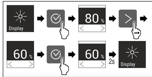
Fig. 83 Beispielhafte Darstellung: Von 80 % zu 60 % wechseln.
