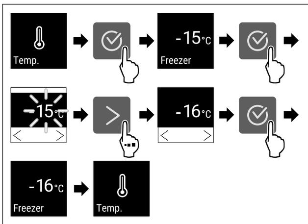
Fig. 65 Temperaturwechsel von -15 °C auf -16 °C
