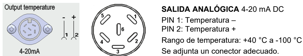
Figura 20: Configuración del pin del conector (10) para la opción salida analógica
