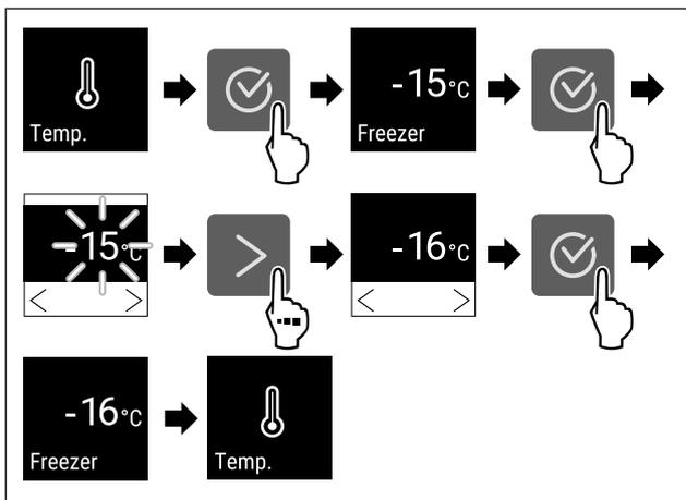
Fig. 68 Variazione di temperatura da -15 °C a -16 °C
