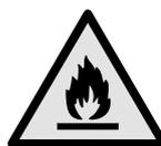
**ATTENZIONE:** pericolo di incendio/materiali infiammabili. Il simbolo si trova sul compressore d'aria e segnala il pericolo di sostanze infiammabili. Non rimuovere l'adesivo.
