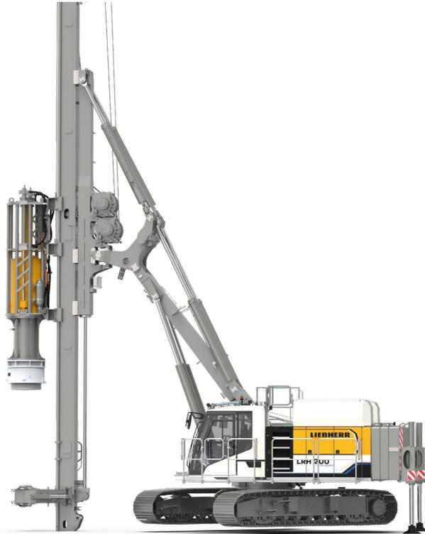
Durch Abstützen des Mäklers auf dem Boden und Ausfahren der Heckabstützzylinder wird das Trägergerät angehoben. Der Unterwagen kann nun in der Luft gedreht werden, was bei beengten Platzverhältnissen das Bewegen des Rammgerätes erleichtert.
