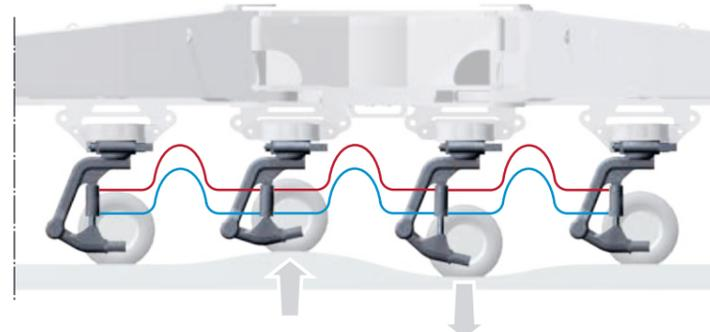
Распределение нагрузки и единая система подвески колесных групп является оптимальной для передвижения по неровной поверхности
